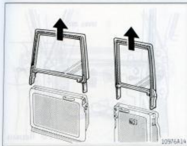
(a) Removing door frames
